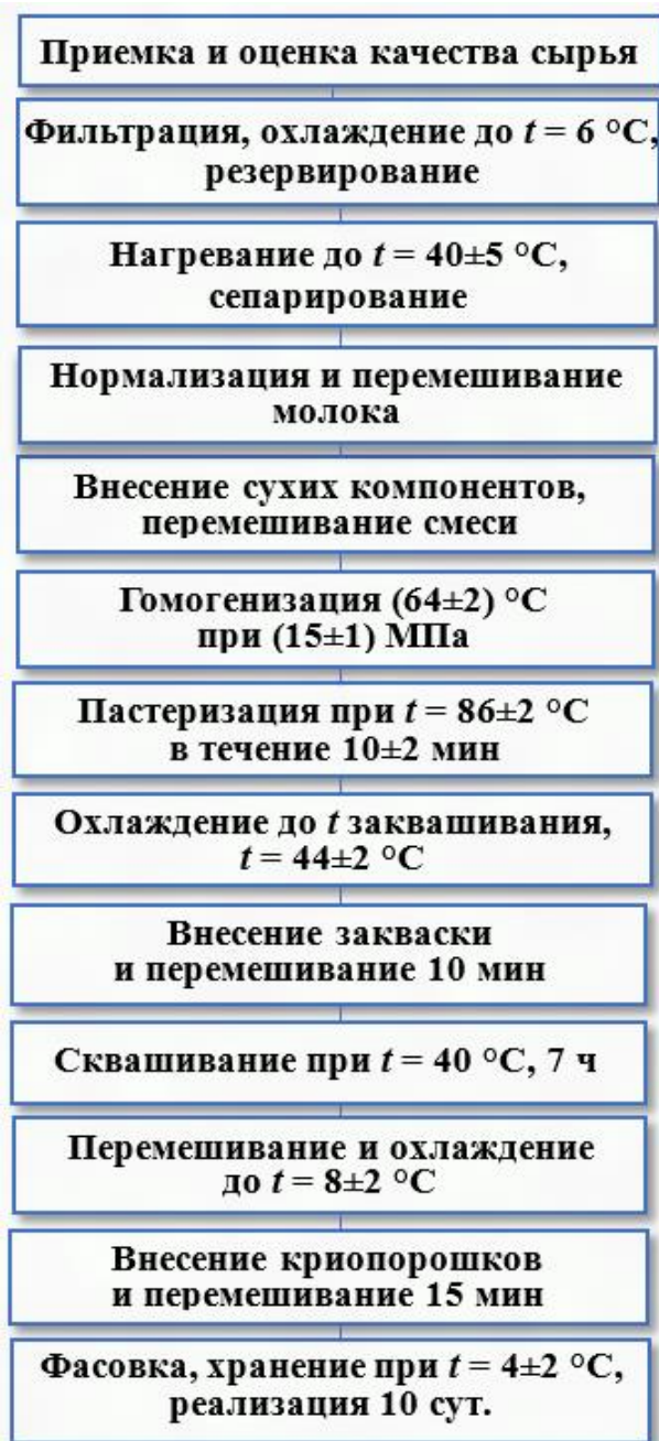
Рисунок 33 – Технологическая схема производства ацидофилина с криопорошком
