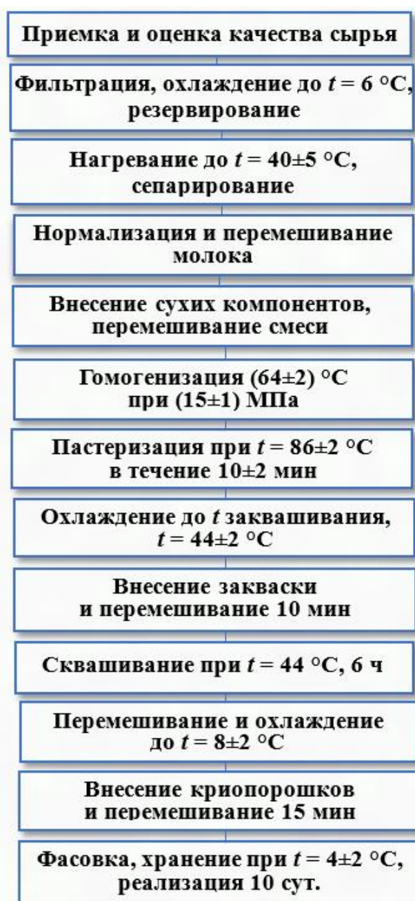
Рисунок 34 – Технологическая схема производства биоюгурта с криопорошком
